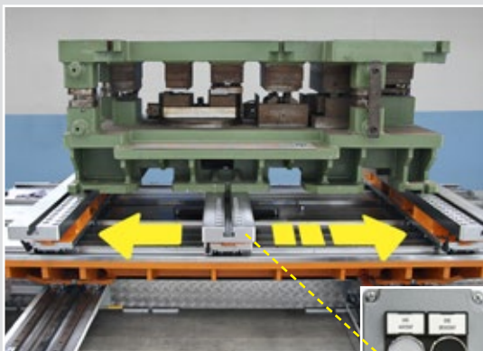
Motores hidráulicos en paralelo permiten mover las paralelas de amarre pulsando un botón, para encontrar la posición de izquierdas a derechas
