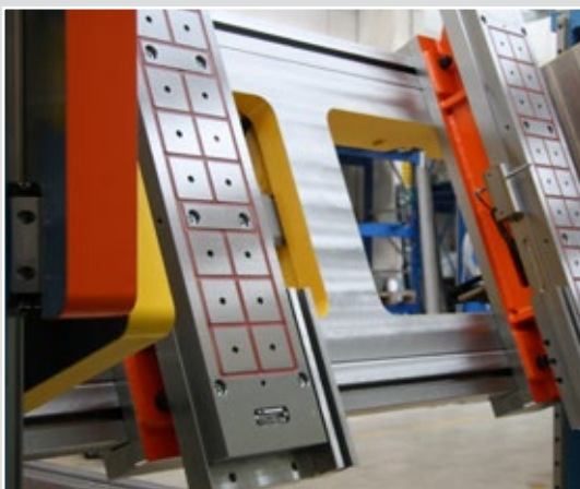
Placas Magnéticas permanentes (sumamente práctico para amarrar en pocos segundos simplemente pulsando un botón)
